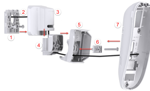
Рисунок 4 – Монтаж камеры HD77 на поворотном кронштейне
